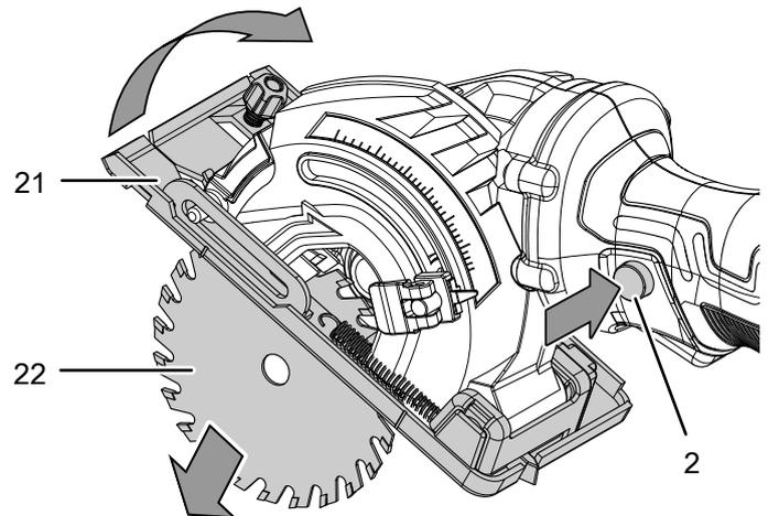
10. Remarquez que pour l'insertion de la lame, la plaque de base (21) doit être renversé en arrière.
