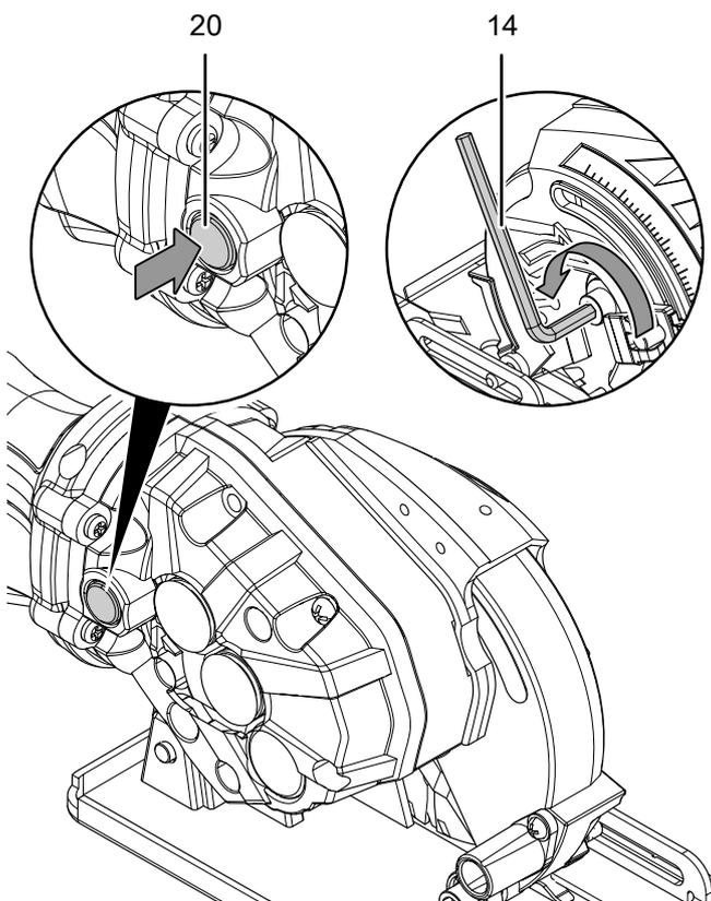
16. Serrez la vis de serrage (23) avec la clé Allen (14).
