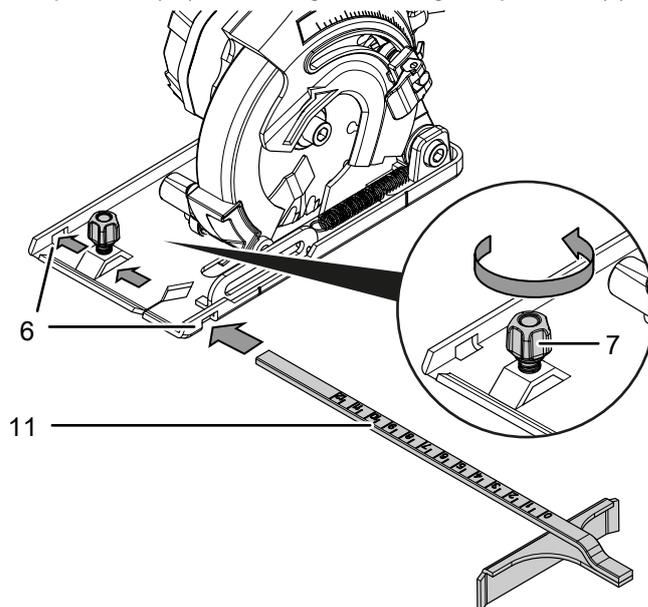
2. Réglez l'écart désiré entre la ligne de coupe et le bord de la pièce à usiner (largeur de coupe) au moyen de l'échelle du guide parallèle (11) et la flèche de marquage (28) de la plaque de base.
