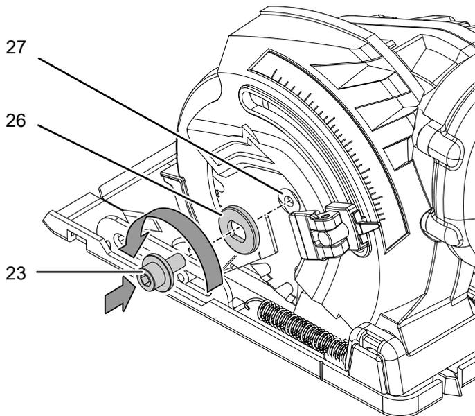
14. Placez la vis de serrage (23) sur la bride de serrage (26).
